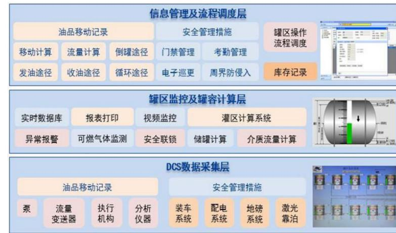
图1 罐区整体解决方案架构
